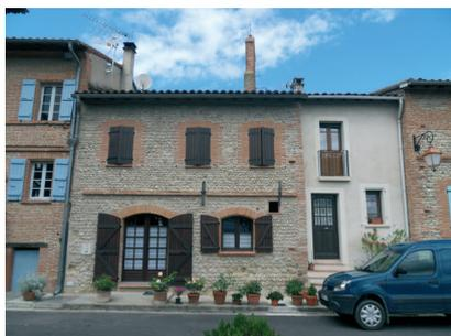
Des détails peuvent être repris pour assurer la diversité des aspects de façades : cordon d'un ou deux lits de brique au niveau des planchers d'étage, appuis de fenêtre en brique foraine, encadrement des baies et tableaux souligné par un bandeau peint de 18 à 20 cm de largeur, oculus de ventilation de comble, petite ouverture carrée ou tableau de 4 foraines posées en losange ou rosace moulée en terre cuite.
